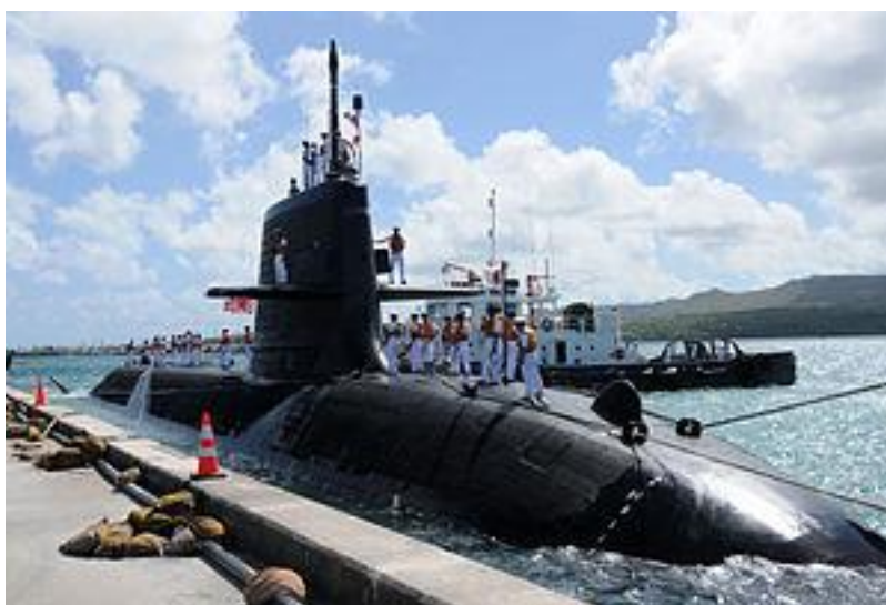
Рисунок 8 – Японская подводная лодка с силовой установкой на основе двигателя Стирлинга.
