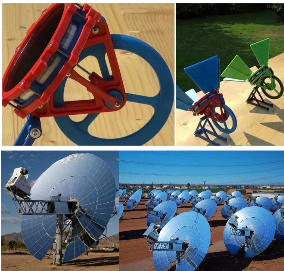
Рисунок 7 - Двигатели Стирлинга, работающие на солнечной энергии.
