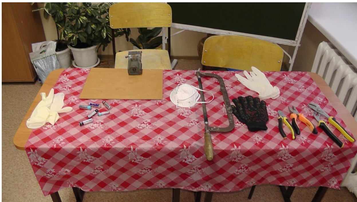
Инструменты для распиливания батареек и соблюдения мер предосторожности.
