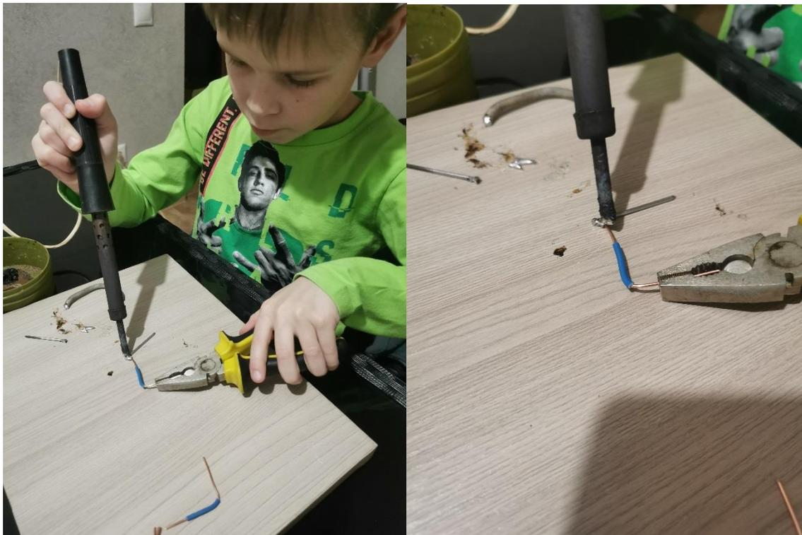
Рис.6 Процесс изготовления соединений
