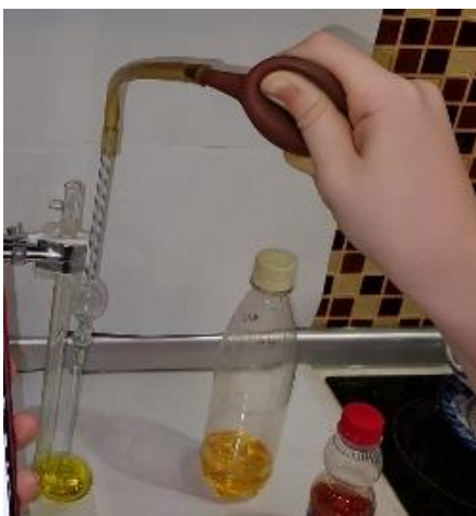
з) Засасывали масло в колено 1 при помощи трубки и резиновой груши
