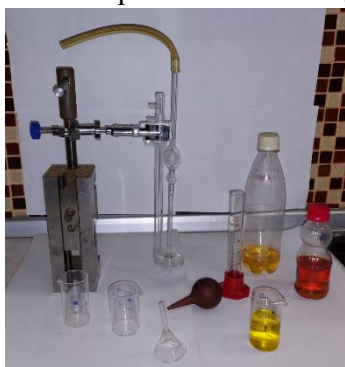
а) Закрепление вискозиметра на штатив
