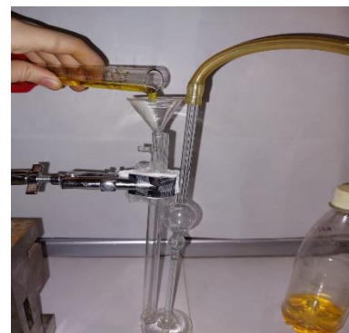
в) Залили минеральное масло в вискозиметр с помощью воронки
